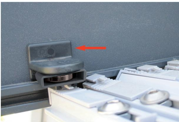
10.) Das Paket (alle Klettprofile) je nach Wunsch zur Haus- oder Gartenseite schieben. Den Gegenmagnet (Wandhalter mit Magnet) zum Anschrauben oberhalb des Längsprofils positionieren.
