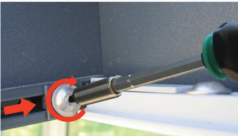
8.) Stopper in den Gleiter des Klettprofils drücken und festschrauben.
