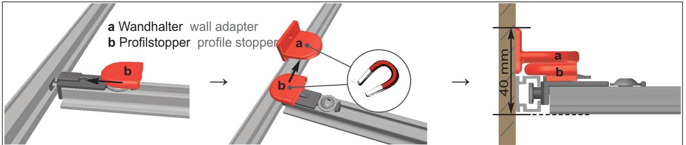
**Optional: Magnet-Stopper Set flache Ausführung - zum Arretieren bei Dachneigung**
