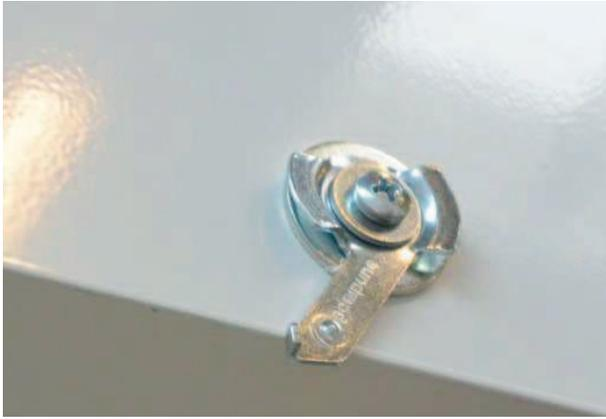
1.) Spannriegel am Balken montieren - **nicht zu fest**, Hebel muss bewegbar sein!
