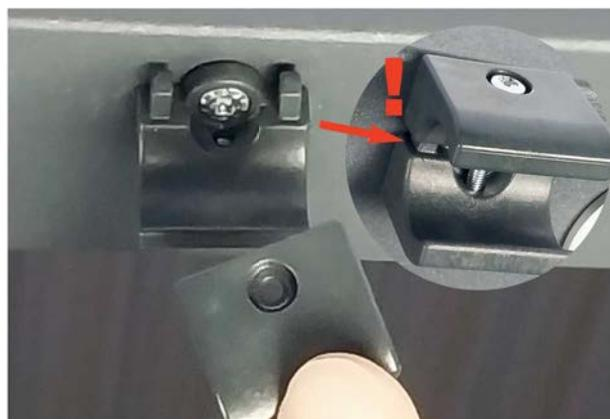
2.) Die zweite Hälfte des Deckenclips mit der ersten Hälfte lose zusammenschrauben - **etwas Spiel zwischen den Hälften lassen**.
