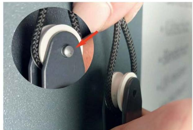
8.) Umlenkrolle und Splint einsetzen.
