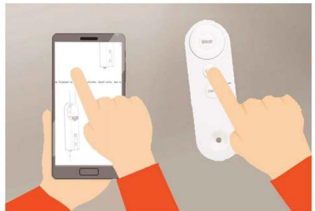
15.) Motoren App installieren oder Fernbedienung programmieren (gemäß beiliegender Anleitung). Anlage entsprechend einstellen, synchronisieren und testen.
