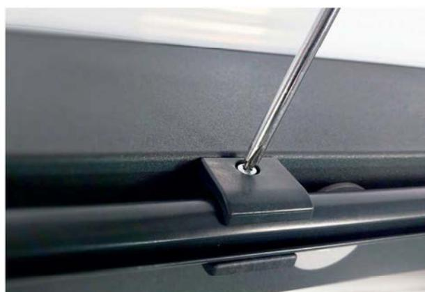
4.) Jetzt die Deckenclip-Schraube festziehen.
